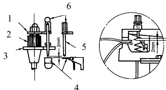
После опускания рычага необходимо приложить к педали дополнительное усилие, чтобы сработал микровыключатель. Зазор между наконечником 5 микровыключателя и неподвижной планкой 4 требует специальной регулировки, т.к. в противном случае процесс сварки может вообще не начаться.
